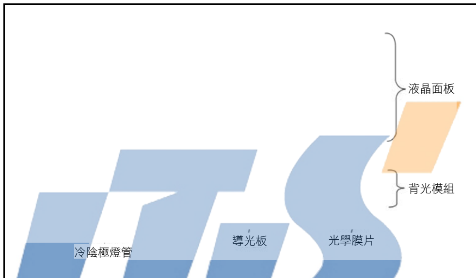
圖 5-1-1 TFT LCD 面板結構
