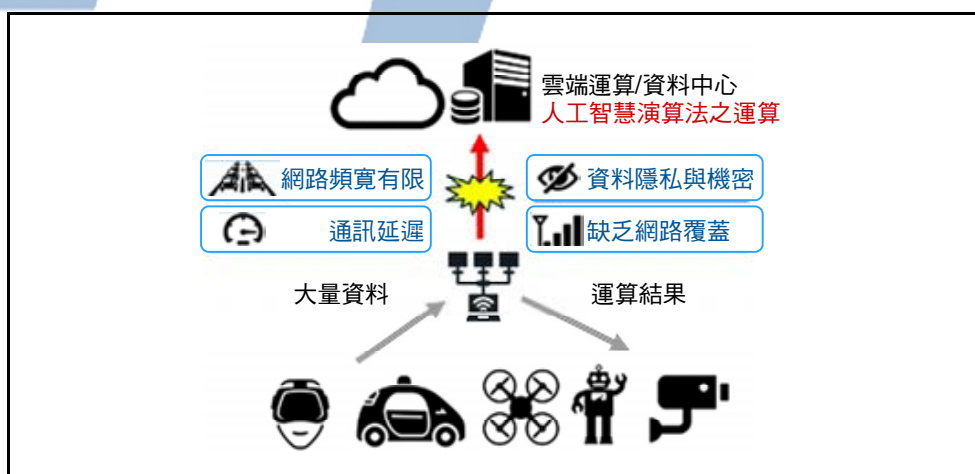
圖 3-1-1 將運算工作由雲端轉移至終端或近端，稱為邊緣運算
